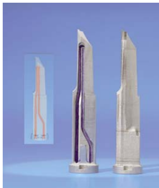
Вставки для форм с каналами охлаждения, расположенными по контуру для повышения эффективности.
